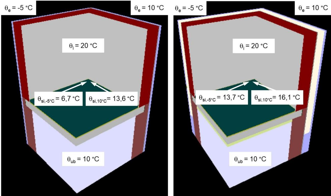
Abbildung 51: Schlafzimmer: minimale Oberflächentemperaturen für den Fall 1 und Fall 2 für jeweils -5 und 10 °C
