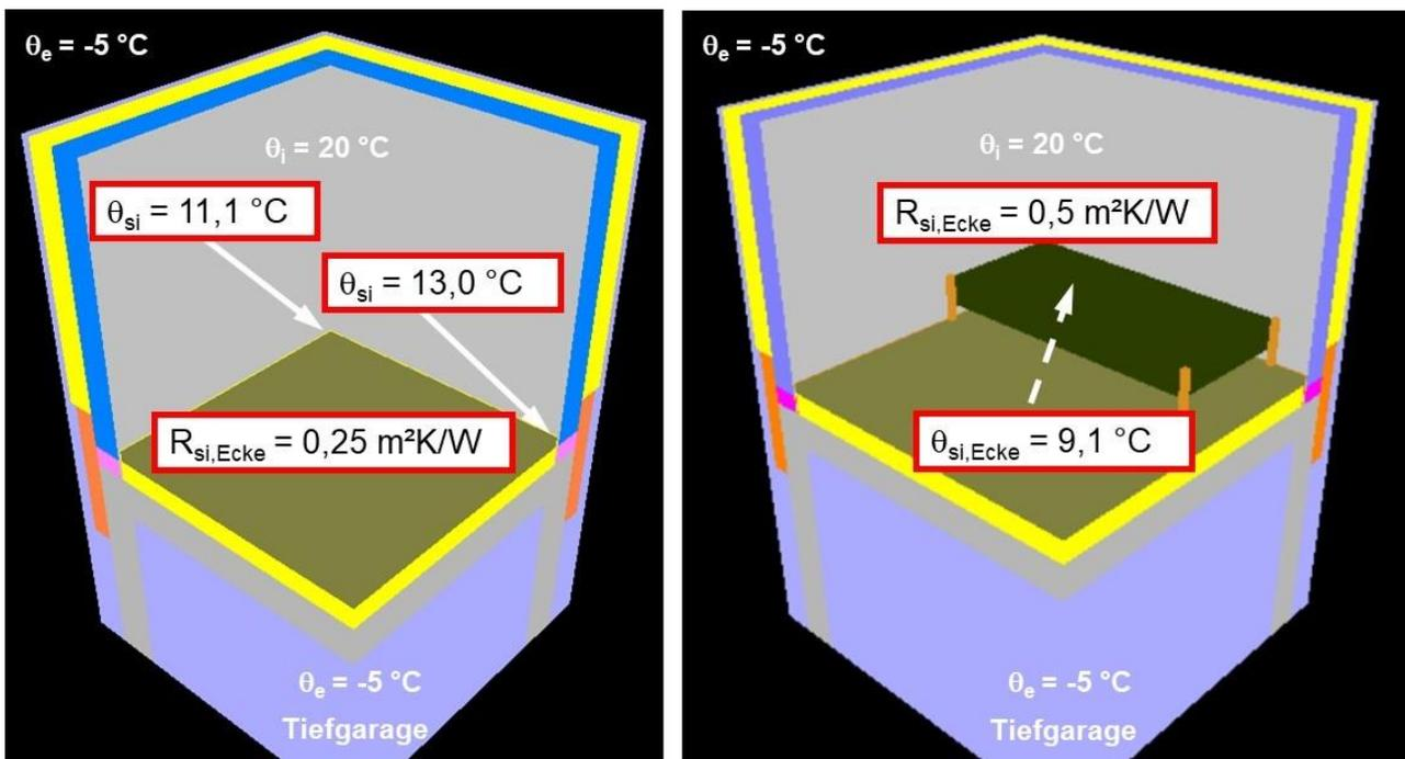
Abbildung 13: Oberflächentemperaturen unter stationären Randbedingungen nach DIN 4108-2
