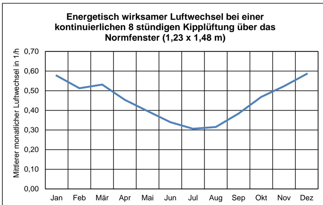
Abbildung 23: mittlere energetisch wirksame Luftwechsel für ein 38 m<sup>3</sup> (= 15 m<sup>2</sup>) großes Schlafzimmer, das kontinuierlich über 8 Stunden für die Dauer der Feuchtfreisetzung gelüftet wird über das auf Kipp stehende Normfenster belüftet wird
