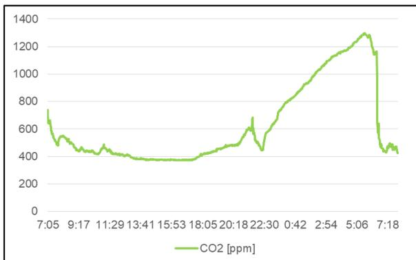
Abbildung 3: Gemessene CO<sub>2</sub>-Konzentration in einem Schlafzimmer mit 50 m<sup>3</sup> Rauminhalt und 2 Personenbelegung bei nächtlich geöffneter Tür zum angrenzenden Wohnraum mit ca. 280 m<sup>3</sup> Rauminhalt und morgendlichem Fensteröffnen vom 21.9. bis 22.9.2020
