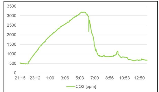
Abbildung 4: Gemessene CO<sub>2</sub>-Konzentration in einem Schlafzimmer mit 50 m<sup>3</sup> Rauminhalt und 2 Personenbelegung bei nächtlich verschlossener Tür vom 9.9. bis 10.9.2020
