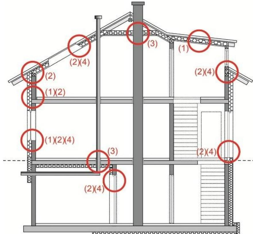
Abbildung 34: Prinzipielle Orte mit Undichtheiten in der wärmeübertragenden Umfassungsfläche, Quelle: FLiB. e.V.
