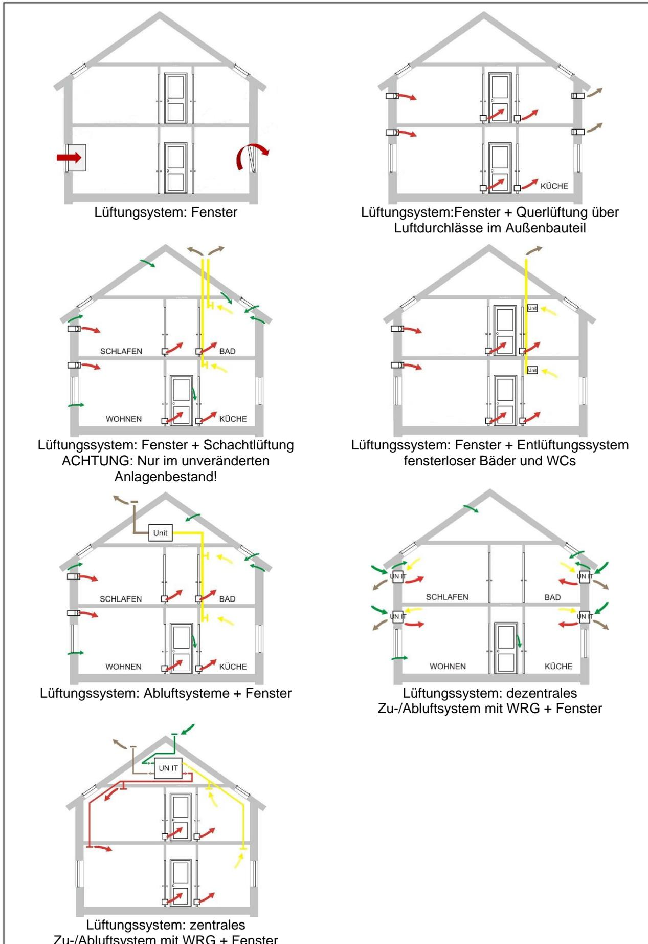
Abbildung 72: Übersicht der behandelten Lüftungssysteme, Quelle: Berhorst / Reiners
