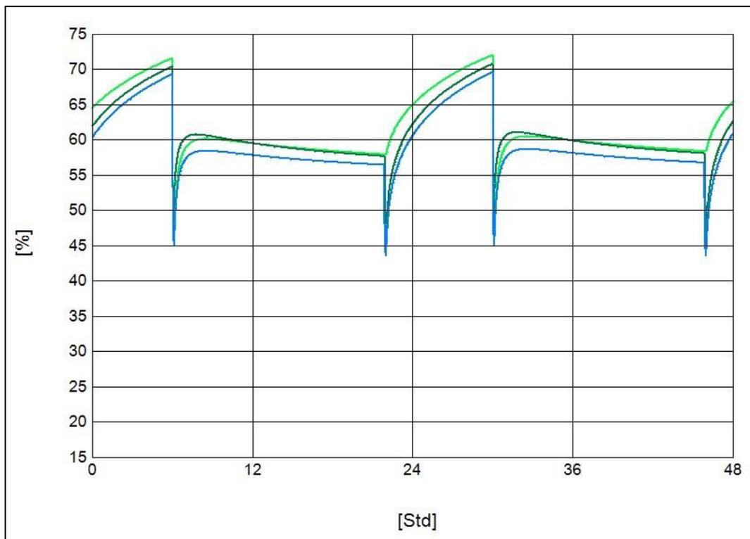
Abbildung 56: Ergebnisse unterschiedlicher Lüftungsstrategien für den energetisch modernisierten Altbau – Auswirkung auf die relative Feuchte der Innenluft im Schlafzimmer infolge Ad- und Desorption,  $\theta_e = 10 \text{ °C}$ ;  $\phi_e = 80 \%$
