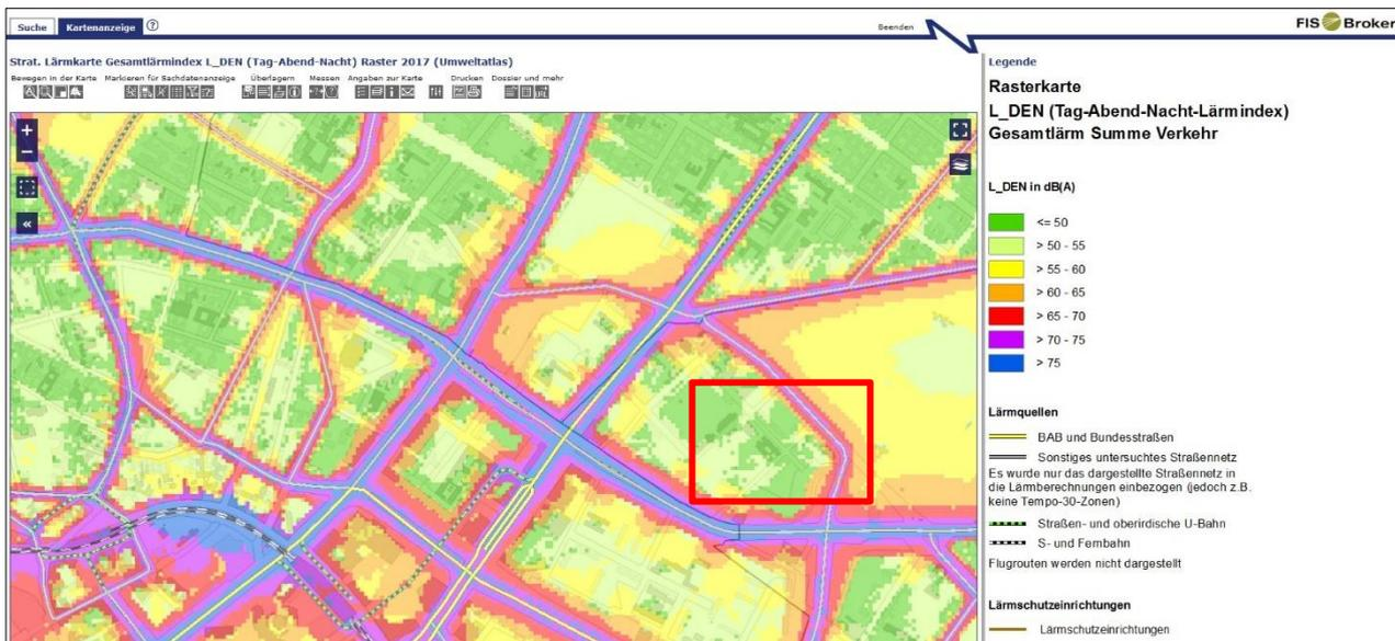
Abbildung 27: Lärmkarte Berlin Umgebung Alexanderplatz (mit  $L_{DEN}$ -Werten können für eine erste Einschätzung des Außenlärms verwendet werden) [30]
