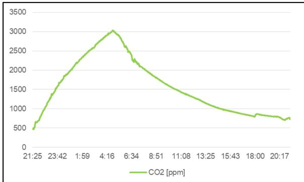
Abbildung 2: Gemessene CO<sub>2</sub>-Konzentration in einem Schlafzimmer mit 50 m<sup>3</sup> Rauminhalt und 2 Personenbelegung bei ganztägiger verschlossener Tür vom 9.9. bis 10.9.2020
