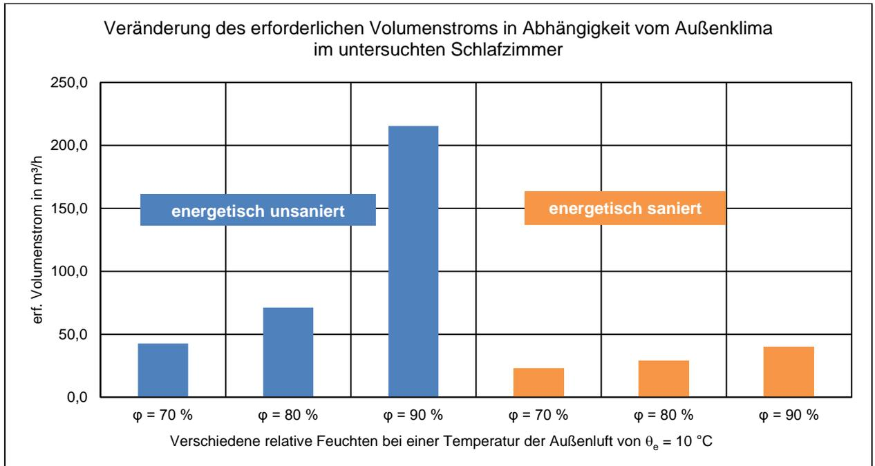
Abbildung 53: Veränderung der erforderlichen Volumenströme in Abhängigkeit vom Dämmstandard und der relativen Feuchte außen
