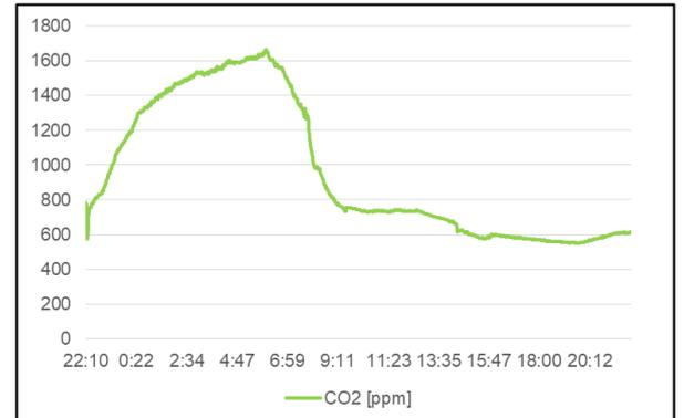
Abbildung 5: Gemessene CO<sub>2</sub>-Konzentration in einem Schlafzimmer mit 50 m<sup>3</sup> Rauminhalt und 2 Personenbelegung mit feuchtegeregeltem Abluftsystem nach DIN 1946-6 vom 7.10. bis 8.10.2020
