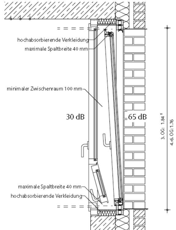
Abbildung 29: Labormessung am „HafenCity-Fenster“ und konstruktive Einbindung [32], Fotoquelle: Grundstücksgesellschaft Shanghaiallee / HafenCity GbR und Zeichnung: Wandel Lorich Architekten
