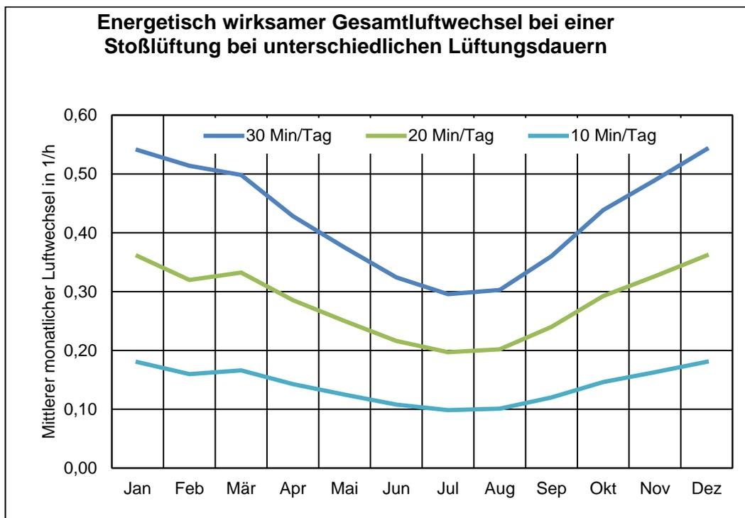
Abbildung 24: mittlere energetisch wirksame Luftwechsel für ein 38 m<sup>3</sup> (= 15 m<sup>2</sup>) großes Schlafzimmer, das über 30 Minuten, 20 Minuten bzw. 10 Minuten über das vollständig geöffnete Normfenster (lichtes Öffnungsmaß: 0,99 x 1,24 m) pro Tag belüftet wird, Klimastandort Potsdam gemäß DIN V 18599-10.
