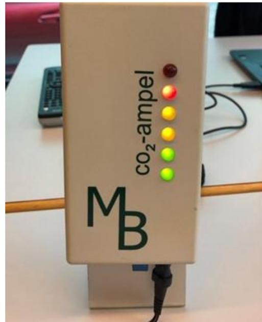
Abbildung 20: Messensor mit Ampelfunktion zur vereinfachten Visualisierung des CO<sub>2</sub>-Gehalts
